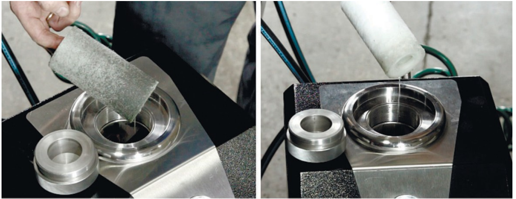
Figura 4. Elemento filtrante después del primer ciclo de lavado (a la izquierda) y al finalizar el lavado (a la derecha).
